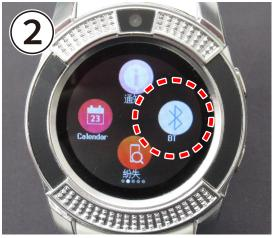
②メニューが表示されたら、左図のメニューが表示されるまで①同様にスワイプし、左図のメニューが表示されたら【BT】>【マイデバイス】> 【Bluetoothデバイスを】の順にタッチしてください。
