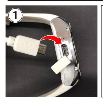
①本体左側面の充電ポートのフタを開け、 付属のコードのmicroUSB端子 (小さい方)を差し込んでください。
