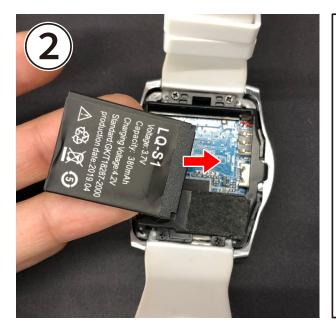
②フタが開いたら付属の電池パックを金 属端子が接触するように、左図と同じ 向きでセットしてください。
